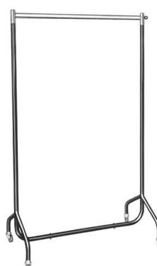
**2282/6** Suport de confectii pentru transport, pliabil si reglabil in inaltime, din teava cu Ø de 25 mm, lacuit maro. Teava portanta este ovala de 30 x 15 mm, cu 2 extensoare lungi de 100 mm, reglabile in inaltime de la 110-170 cm.
